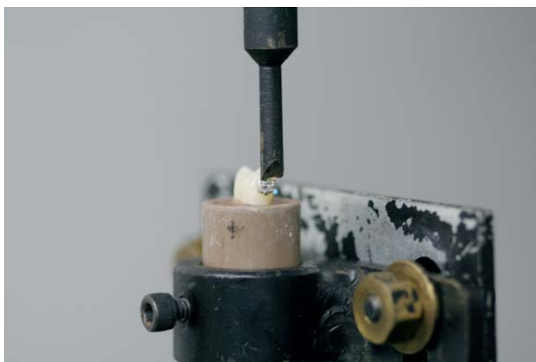
Figura 4 Corpo de prova posicionado à máquina MTS.
